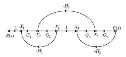
$$(A) \frac{G_1 G_2 G_3 G_4}{1 - G_1 G_2 H_1 - G_3 G_4 H_2 - G_2 G_3 H_3 + G_1 G_2 G_3 G_4 H_1 H_2}$$
