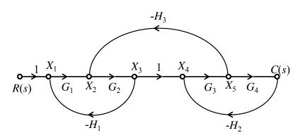
$$(A) \frac{G_1 G_2 G_3 G_4}{1 - G_1 G_2 H_1 - G_3 G_4 H_2 - G_2 G_3 H_3 + G_1 G_2 G_3 G_4 H_1 H_2}$$
