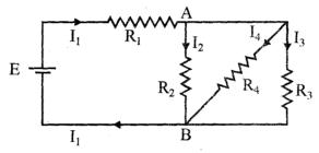
दर्शाये गये परिपथ में,  $R_1=4~\Omega,~R_2=R_3=15~\Omega,~R_4=30~\Omega$  और E=10~V है । इस परिपथ का तुल्य प्रतिरोध तथा प्रत्येक प्रतिरोधक से प्रवाहित विद्युत धारा के मान का परिकलन कीजिये ।
